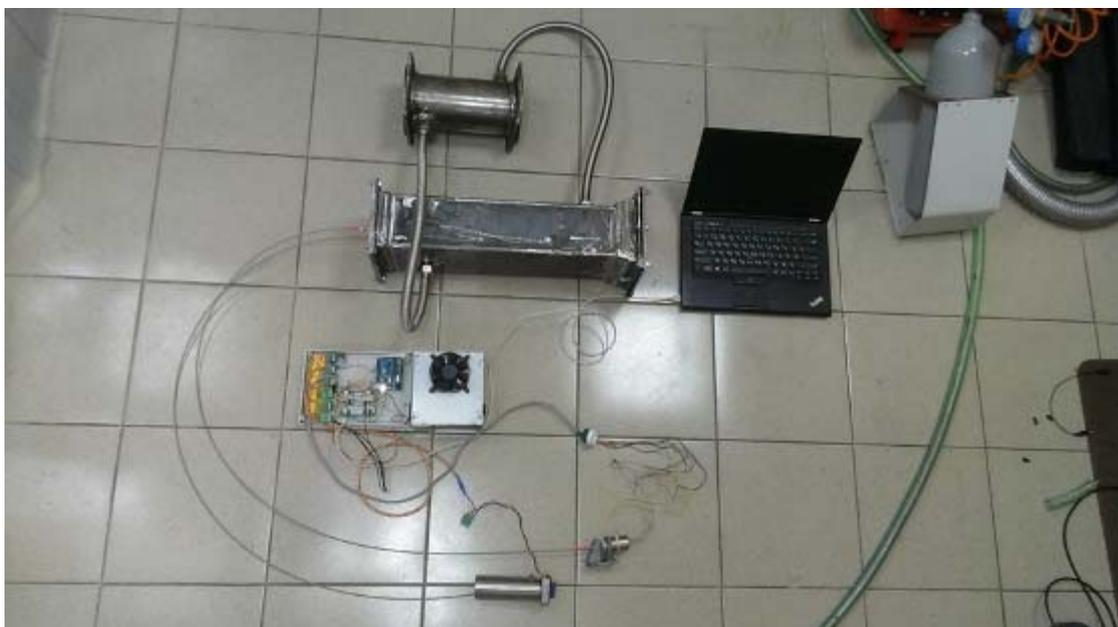
Рис. 6 – Общий вид многопараметрического волоконно-оптического ИК-анализатора газов
