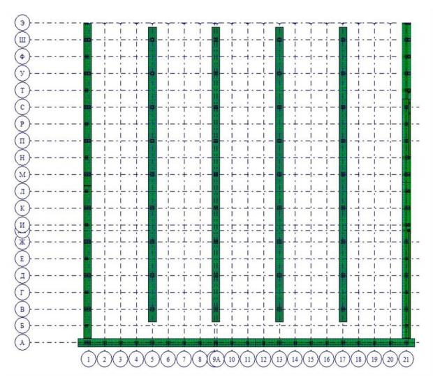
Рис. 1. – Картина давления фундаментных лент основного склада на основание от PCH2 (колонны склада)
