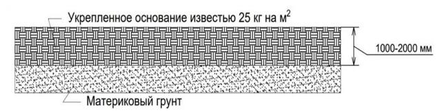
Рис. 4. – Схема усиленного ресайклингом грунтового основания
