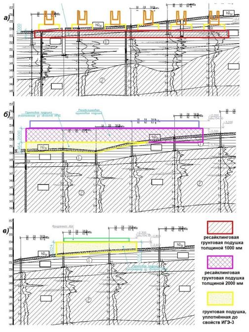
Рис. 6. – Посадка фундаментов на геологическом разрезе: а) основной склад, б) зона антресоли, в) здание АБК
