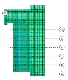
Рис. 3. – Картина давления фундаментной плиты на основание от PCH2 (колонны 3-этажного АБК).
