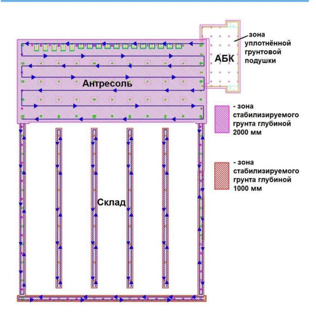
Рис. 5. – Технологическая схема стабилизации грунтов основания
