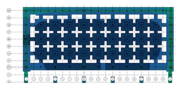
Рис. 2. – Картина давления отдельных фундаментов на основание от PCH2 (колонны 3-этажной антресоли)
