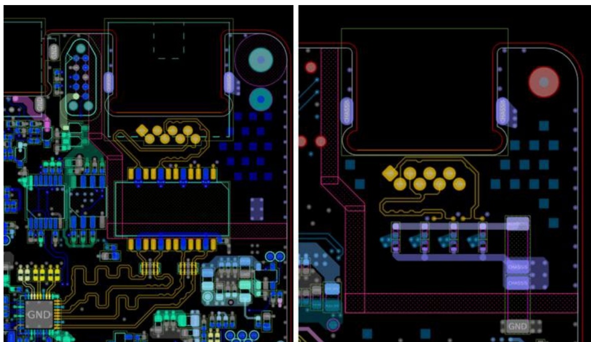
Рис.4. – Внешний трансформатор Ethernet разъема RJ-45.
