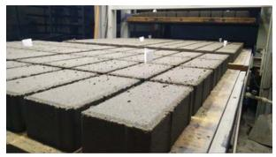
Рис. 2. Внешний осмотр тротуарной плитки («Урбан», состав № 1 табл. 10) после выхода из-под пресса
