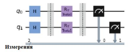
Рис. 3. – Квантовая схема с 2-я кубитами, включая один обучаемый параметр на кубит ( $R_{\nu}$ )
