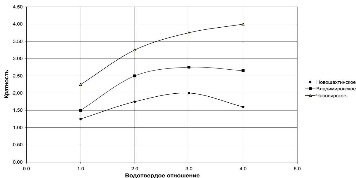
Рис. 1. – Зависимость кратности пеномассы от водотвердого отношения
