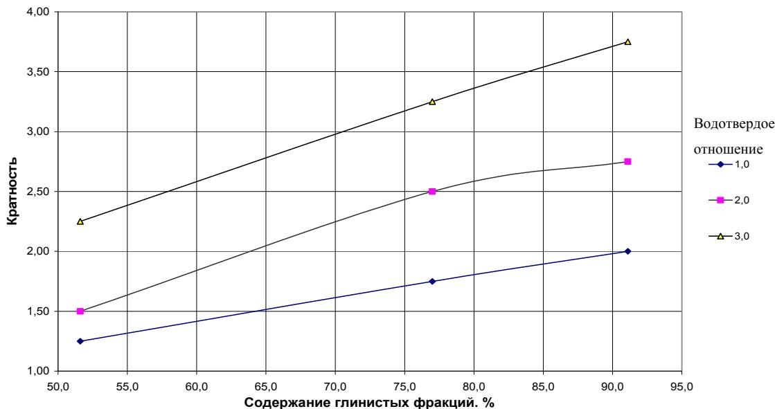
Рис. 2. – Зависимость кратности пеномассы от содержания глинистых частиц
