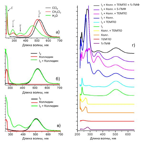
Рис. 4. — Спектры поглощения различных систем: йода в различных растворителях (а); йода, коллидина и их смеси в  $CCl_4$  (б) и в  $CH_2Cl_2$  (в); индивидуальных соединений и мультикомпонентных растворов в  $CH_2Cl_2$  (г).
