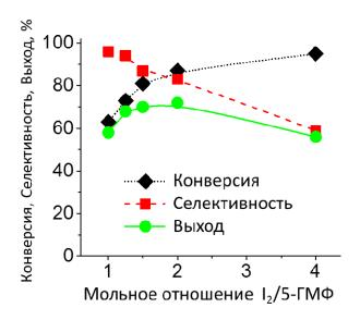
Рис. 1. – Конверсия 5-ГМФ, селективность и выход (по данным ВЭЖХ) 2,5-ДФФ в зависимости от соотношения  $I_2/5$ -ГМФ.
