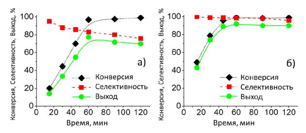
Рис. 2. – Конверсия 5-ГМФ, селективность и выход (по данным ВЭЖХ) 2,5-ДФФ в зависимости от времени реакции а) в отсутствии и б) в присутствии коллидина. Мольное отношение:  $I_2/5$ -ГМФ = 2/1; коллидин/5-ГМФ = 0.25/1; 4-AcNH-TEMПO/5-ГМФ = 0.1/1.
