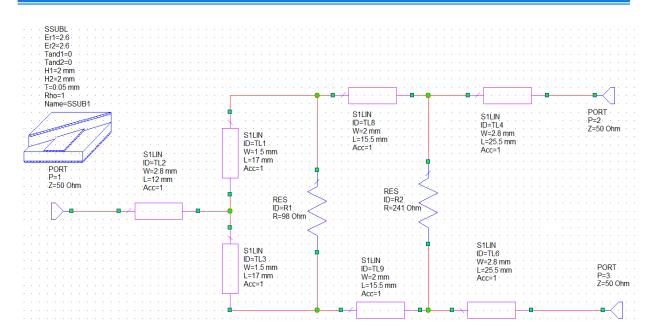
Рис. 1. – Модель делителя мощности в MWO
