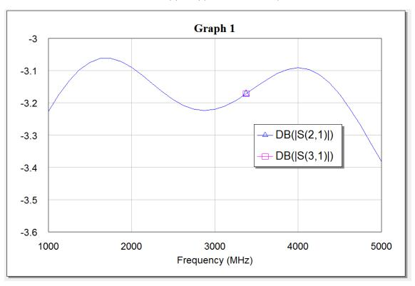
Рис. 2. – АЧХ двух каналов в MWO
