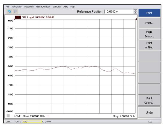
Рис. 4. – Частотная зависимость коэффициента передачи делителя мощности S21
