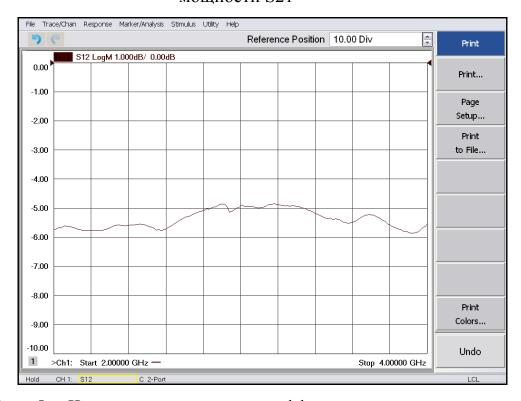
Рис. 5. – Частотная зависимость коэффициента передачи делителя мощности S31
