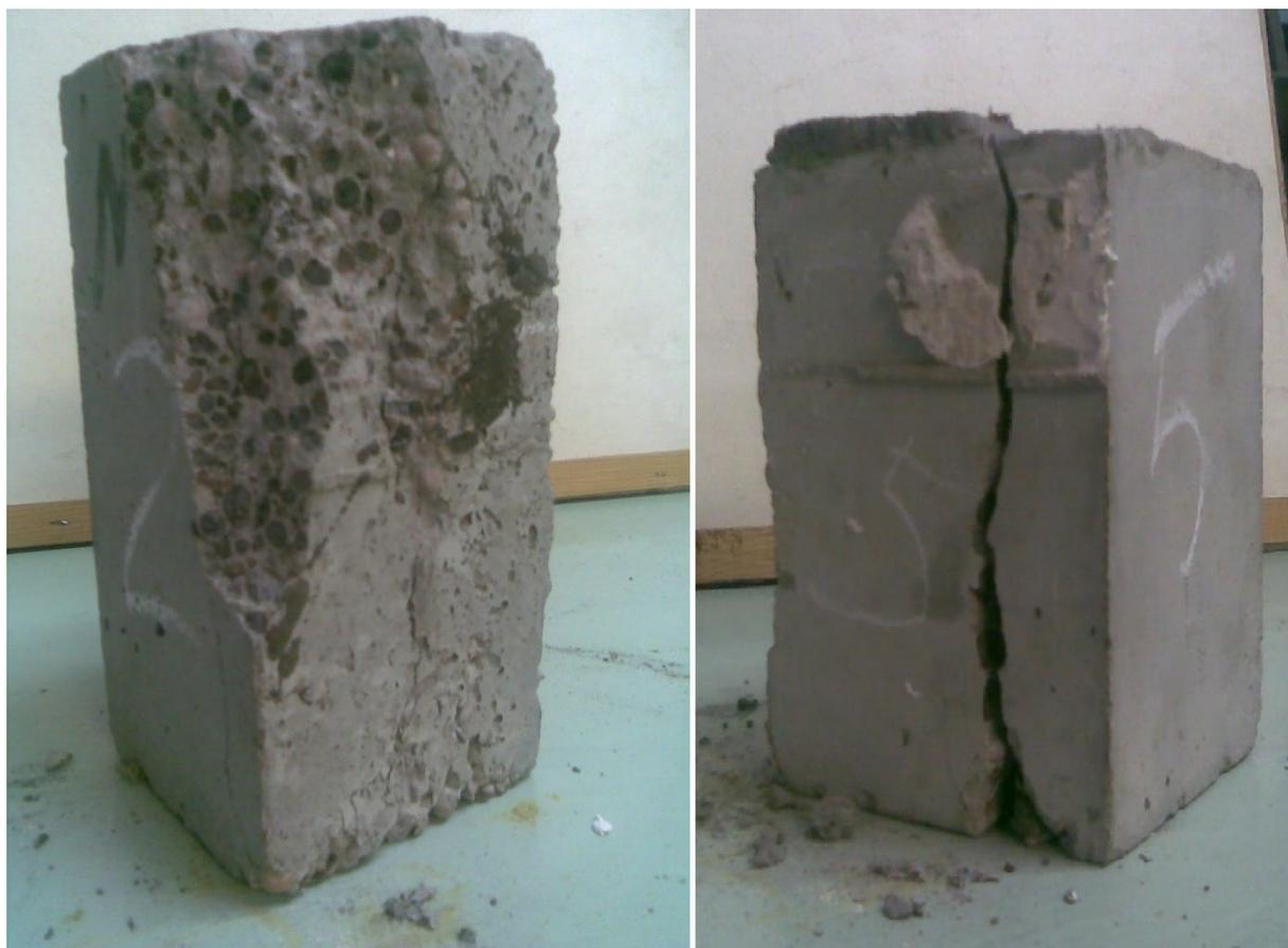
Рис. 4. – Образцы бетона, после испытания.
