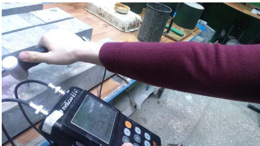
Рис. 3. – Лабораторные исследования с применением прибора Пульсар 2.2
