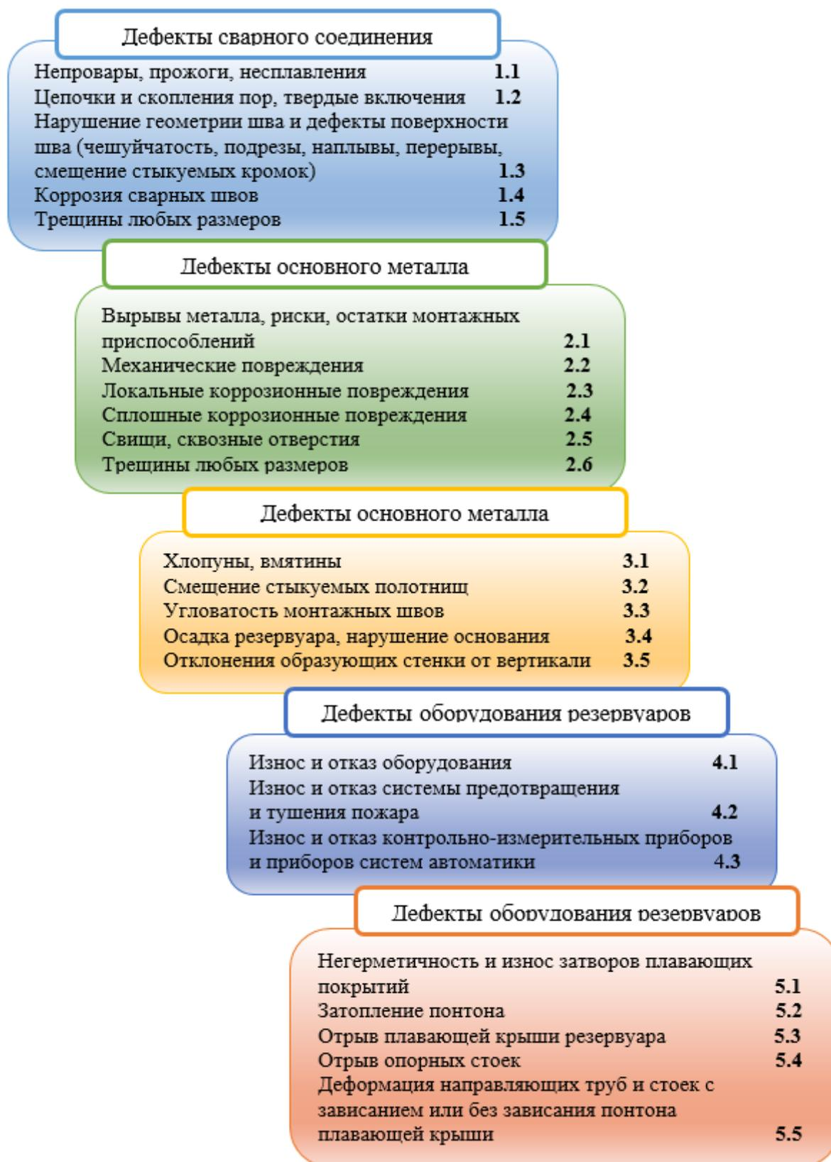
Рис. 1. – Наиболее характерные дефекты, от совокупности которых зависит выбор метода капитального ремонта или реконструкции РВС
