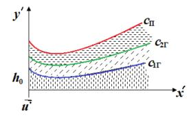
Рис. 1. Схема расслоения смазочного материала на три слоя
