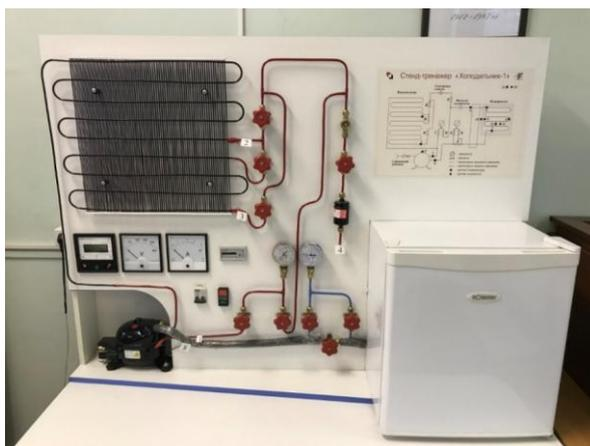
Рис. 2. – Общий вид экспериментально-диагностического комплекса «Холодильник – 1»
