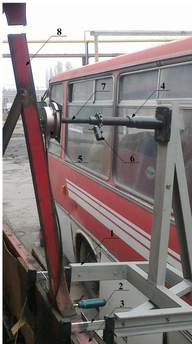
Рис. 1 – Установка для нагружения стоек кузова автобуса
