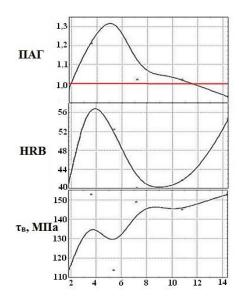
Рис. 1. – Зависимость ПАГ, HRB,  $\tau_{cp}$  от времени размола
