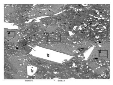
Рис. 2. – Микроструктура ГДПМ Д16-Al-ферротитан в отраженных электронах
