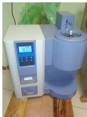
Рис. 1. – Пластомер для определения предельного напряжения сдвига
