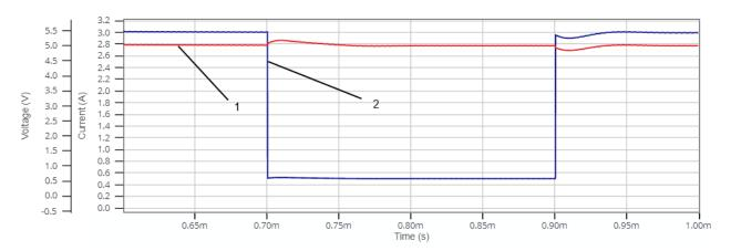
Рис. 4. – Диаграммы при изменении нагрузки (1 – выходное напряжение на нагрузке, 2 – ток нагрузки)
