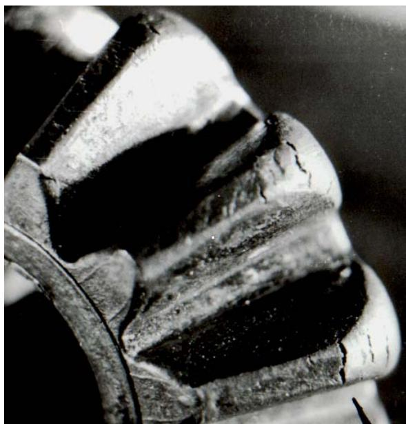
Рис. 1.– Сателлит дифференциала на промежуточном этапе горячей штамповки
