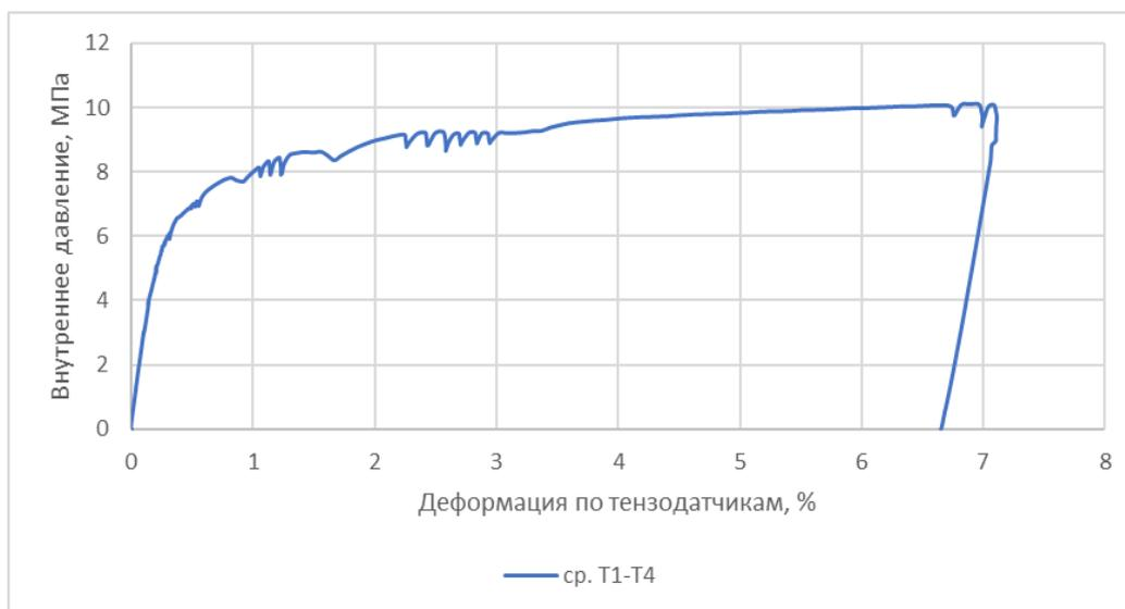
Рис. 5. – Деформация трубы в окружном направлении для образца № 1
