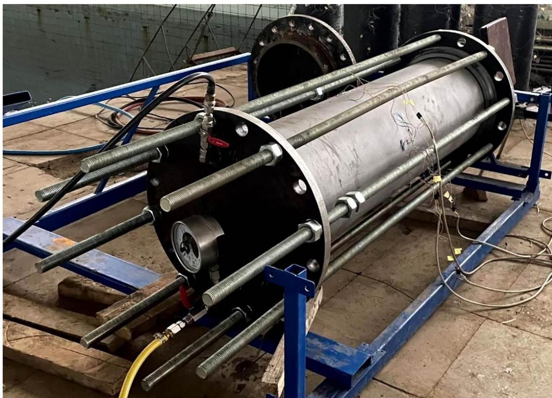
Рис. 3. – Общий вид испытательной оснастки с установленным образцом до проведения испытания
