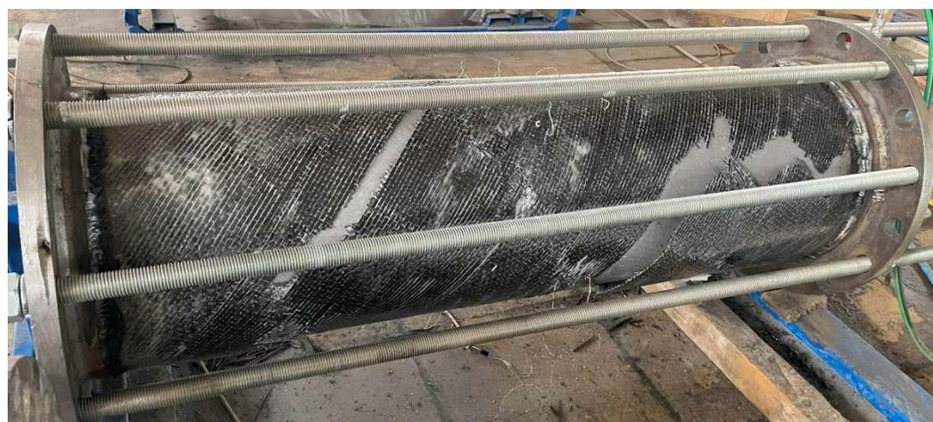
Рис. 7. – Общий вид образца № 3 после разрушения
