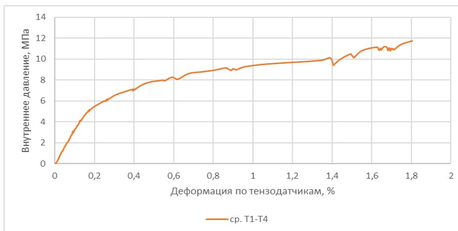
Рис. 11. – Деформация трубы в окружном направлении для образца № 4
