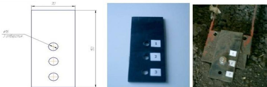
Рис. 4 Чертеж, вид, способ установки, деформация и сколы на грани детали.
