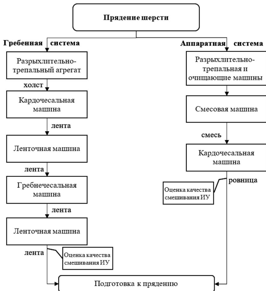
Рис. 2. – Схема расположения измерительных элементов в системах прядения шерсти
