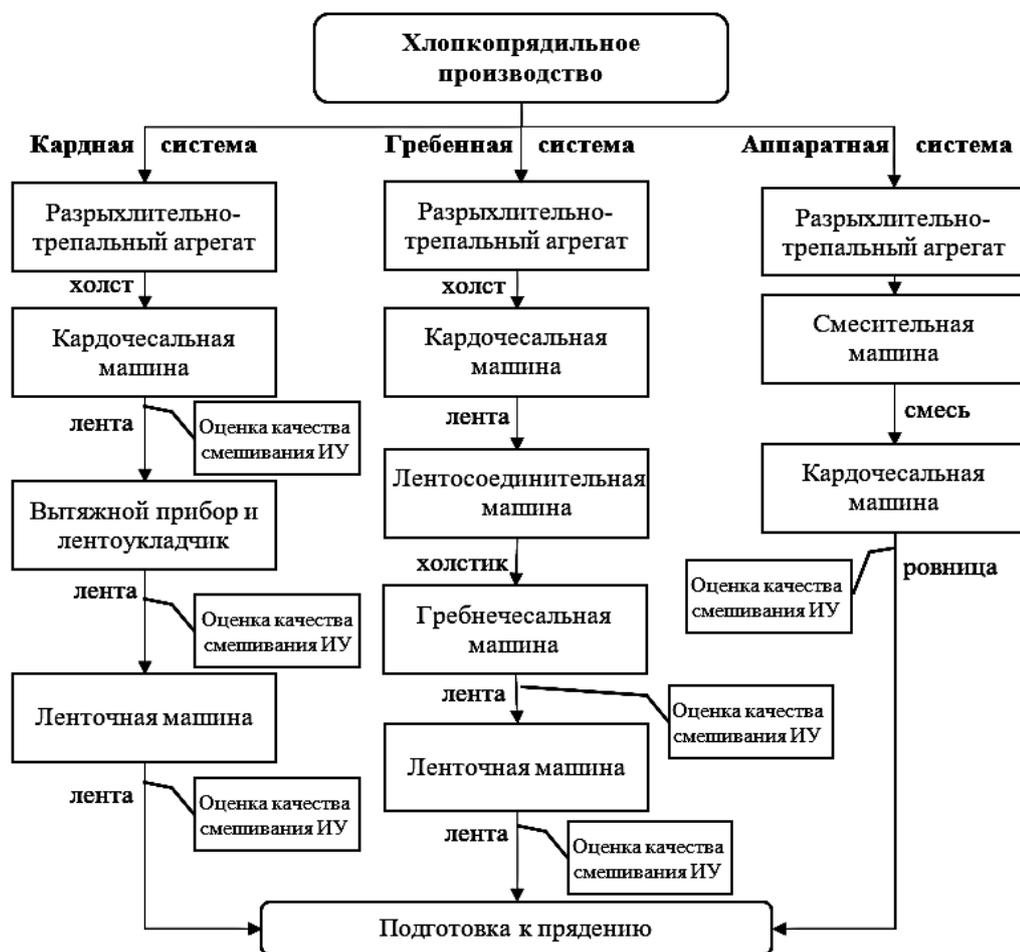
Рис. 1. – Схема расположения измерительных элементов в системах прядения хлопкопрядельного производства
