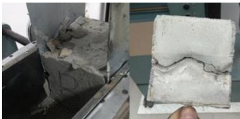
Рис. 3. – Схема разрушения образцов с выкалыванием верхней части (слева) и раскалыванием образца горизонтально (справа)
