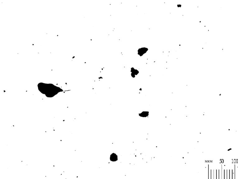
Рис.3. - Фото пыли, зафиксированной на фильтрах
