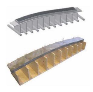
Рис. 5 – Устройство «умной» опалубки.
