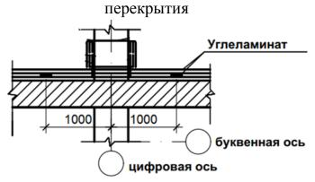
Рис. 3. Узел сопряжения колонны и перекрытия с указанием углеламинатов
