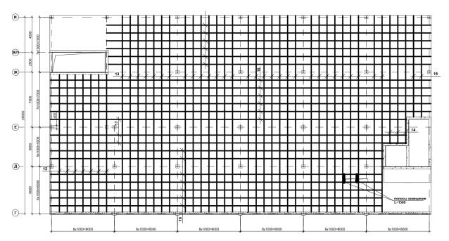
Рис. 2. План расположения материалов усиления железобетонного
