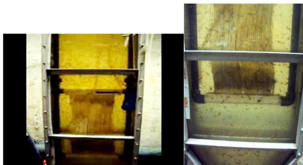
Рис. 5. – Промывка мембранного модуля (слева) и осаждение смытых примесей (справа)
