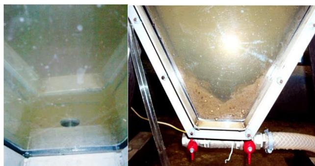
Рис. 6. – Осадок при отстаивании промывной воды без фильтрации через мембранный модуль (слева) и после промывки модуля (справа)
