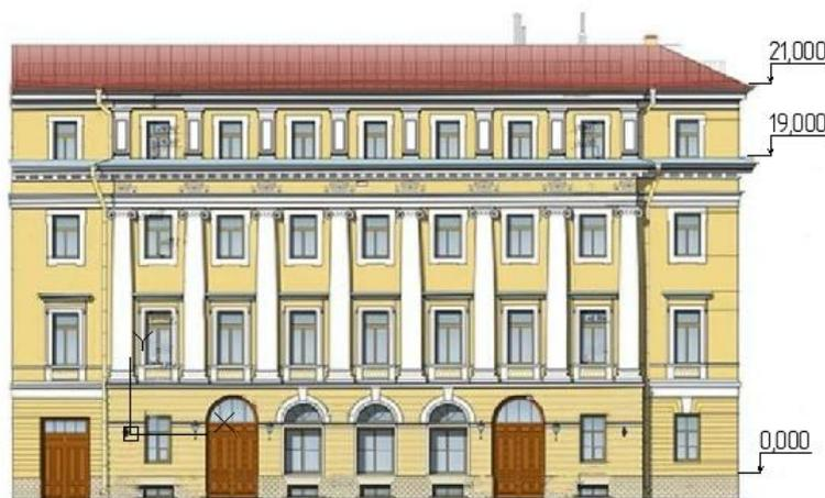
Рис. 3. – Высотные отметки расположения оборудования на фасаде здания
