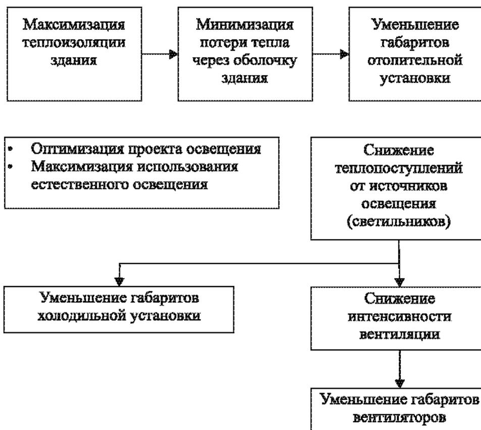
Рис. 1. – Взаимозависимости компонентов здания как единой теплоэнергетической системы [2]
