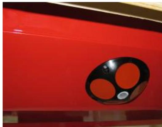
Рис. 3. –Допплеровский лаг скорости, установленный на днище мини-корабля
