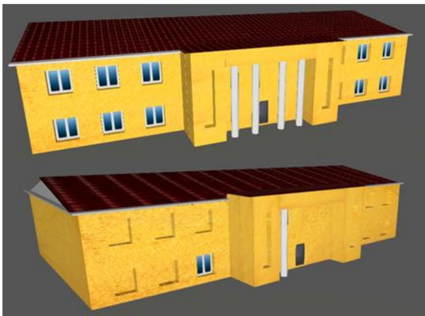
Рис. 1. – Примеры корректного и некорректного импорта 3D-объектов здания из 3Ds Max в программу DIALux evo
