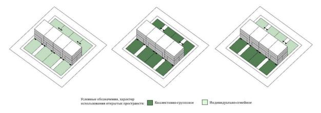
Рис. 5. – Схема архитектурно-пространственной структуры среднеэтажного трехквартирного блокированного дома. Авторская иллюстрация.
