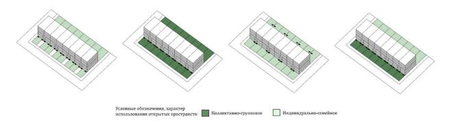
Рис. 4. — Схема архитектурно-пространственной структуры среднеэтажного двухквартирного блокированного дома. Авторская иллюстрация.
