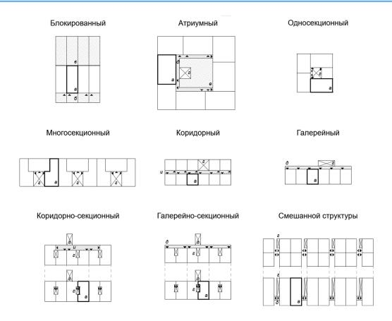
Рис. 1. – Схемы типов среднеэтажных жилых зданий. Авторская иллюстрация.
