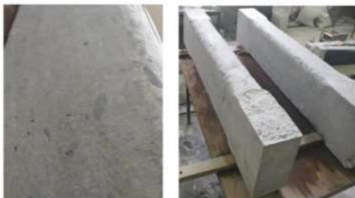
Рис. 6 Общий вид балок и стоек, поверхность которых очищена от цементного молочка, путем обработки поверхности механическим абразивным инструментом.
