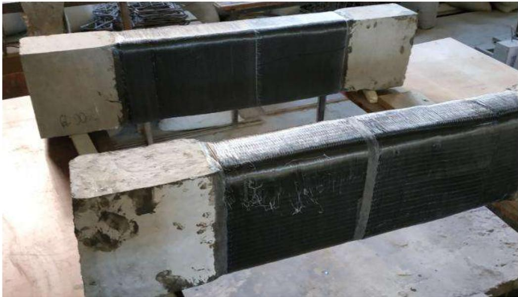
Рис. 11. Общий вид усиленных стоек
