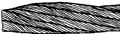
Рис. 6. Местное увеличение диаметра каната
