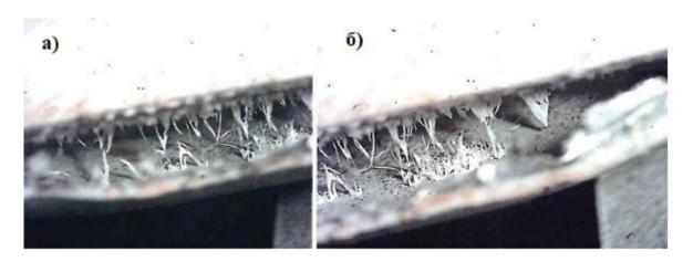
Рис. 4 — Нарушение клеевого слоя в виде застывших вытянутых тонких нитей между слоями образца:
