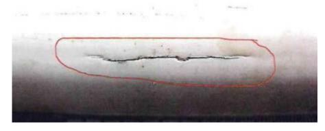
Рис. 3 – Сквозная трещина на наружной поверхности образца трубы типа PP-R/Al/PP-R
