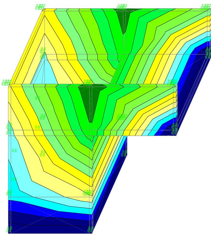
Рис. 1. Эпюра напряжений от статических нагрузок
