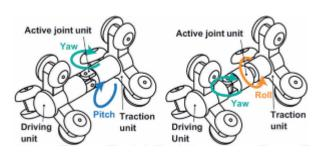
Рис.6. - Общий механизм передвижения в трубе [8]
