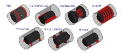
Рис. 1. - Разные типы передвижения внутритрубных инспекционных [2]
