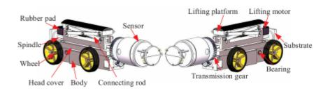
Рис. 4. - Структура внутритрубного колесного робота [5]
