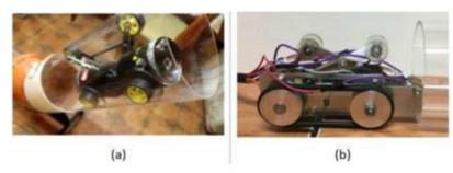
Рис.5. - Прототипы опроно-колесных типов внутритрубных роботов [3]
