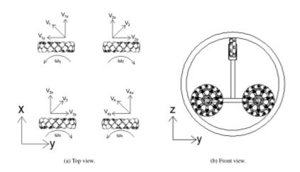
Рис.3. - Схема самоцентрирующихся меканум колес [4]
