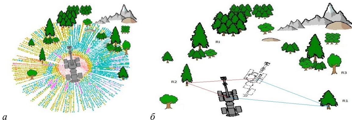
Рис. 3. – Схема работы бортового лазерного сканера кругового обзора
