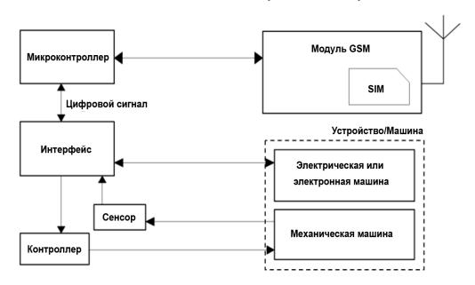
Рис. 1. – Логическая схема системы домашней автоматизации, основанная на сети GSM
