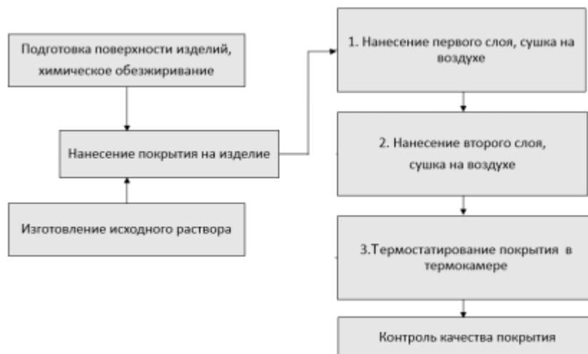
Рис. 1.– Схема формирования покрытия на основе полиизобутилена
