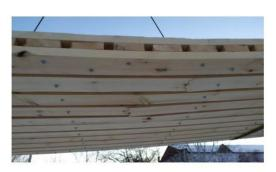
г) Характер разрушения изделия – разрушение отдельных досок
