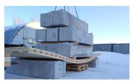
в) Фрагмент загружения изделия при испытании. (Прогиб составляет 235 мм)
