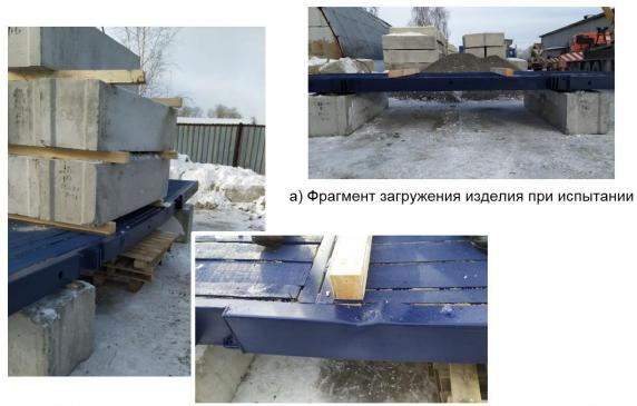
б) Фрагмент загружения изделия при испытании. Произошла потеря местной устойчивости сжатых полок гнутых швеллеров.
