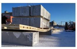
б) Фрагмент загружения изделия при испытании. (Прогиб составляет 136 мм)
