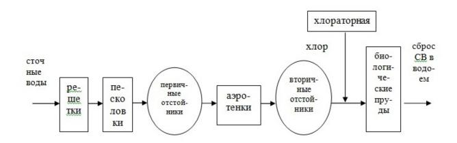
Рис. – Схема существующей очистки сточных вод на Кадамовских очистных сооружениях (г. Новочеркасск)
