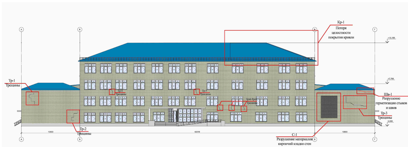
Рис.2. – Пример ЭЦИМ ОКС с дефектами
