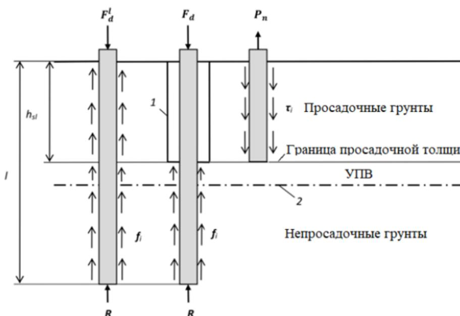
Рис. 1 Схема испытаний одиночной сваи в просадочном грунте.
