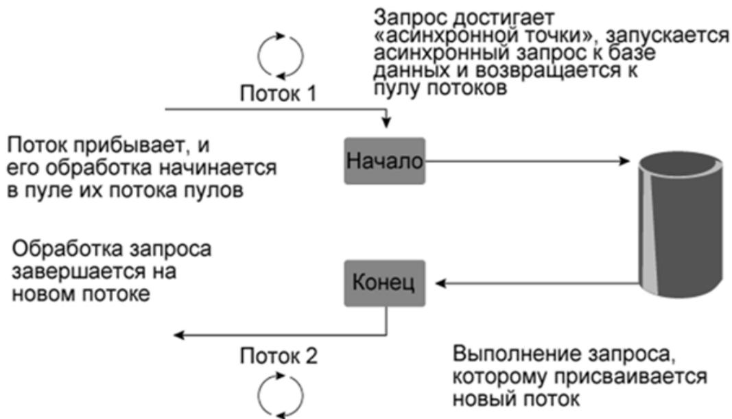
Рисунок 4 - Схема выполнения асинхронного запроса к базе данных.
