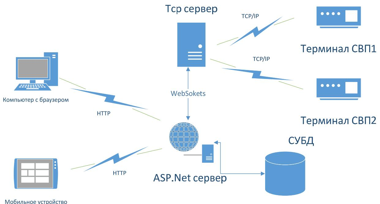
Рисунок 1- Общая структура серверного диспетчерского программного обеспечения
