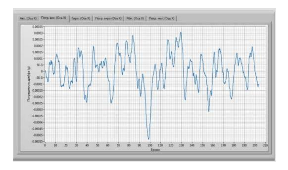
Рисунок 6 - Погрешность МЭМС акселерометра
