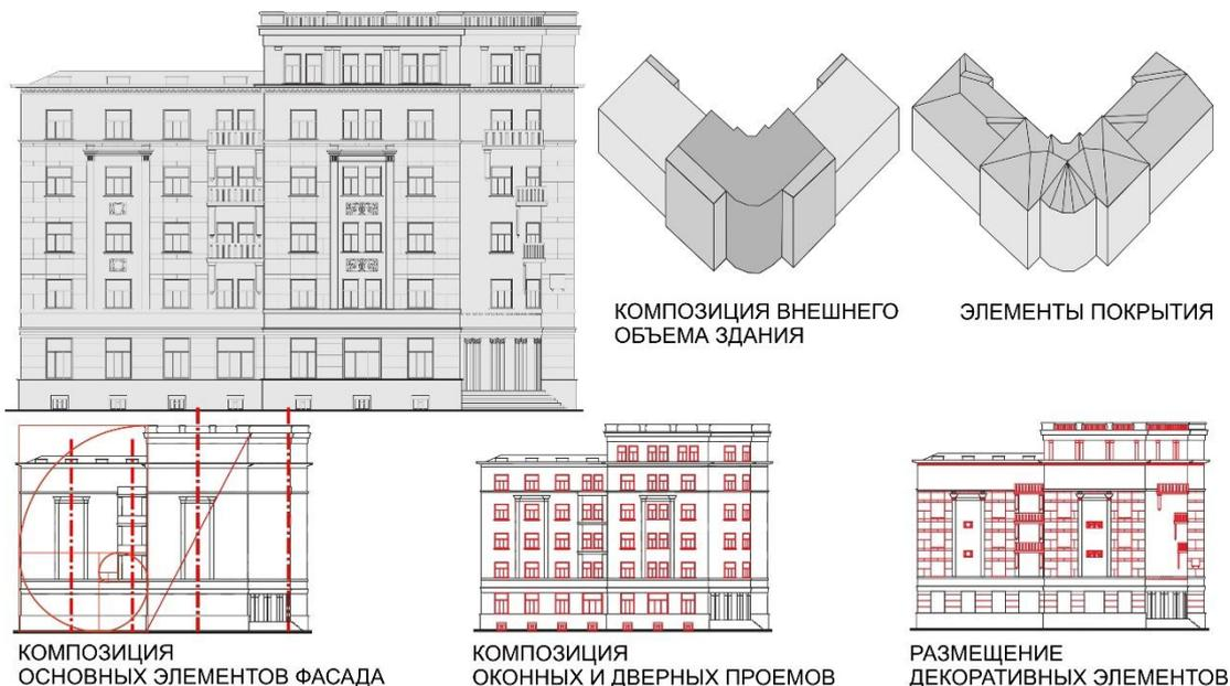
Рис. 3. Анализ объемно-пространственного решения здания Типа 2. Жилые здания со скошенным углом
