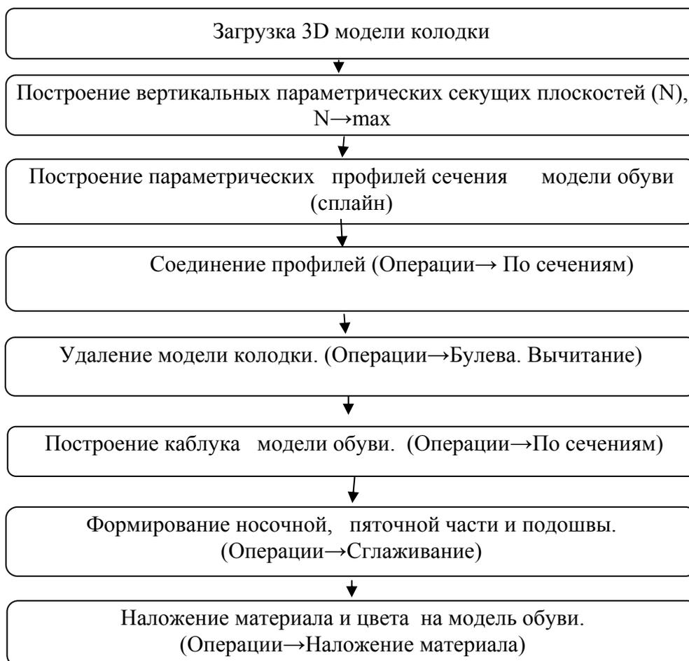
Рис. 3. – Блок-схема методики параметризации трехмерной модели обуви
