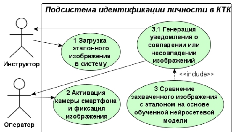
Рис. 1. – Функциональные требования к подсистеме идентификации оператора в мобильном тренажере
