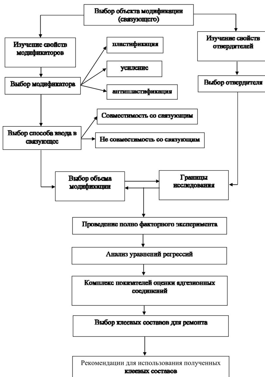
Рис. 1 – Структурная схема метода химической модификации эпоксидных композиций
