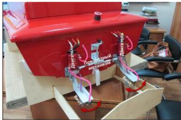
Рис. 3. – Двигательный рулевой комплекс мини-корабля
