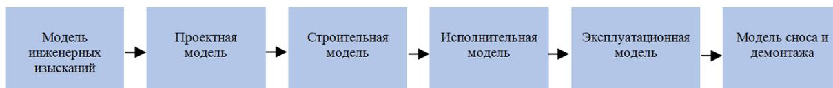
Рис. 1. – Общая структура информационной модели железной дороги
